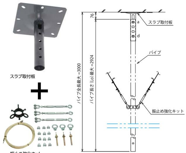
※DH-31A/AKは安全のため、a穴とd穴の2箇所固定します。M12×70貫通ボルトセット×2付属
