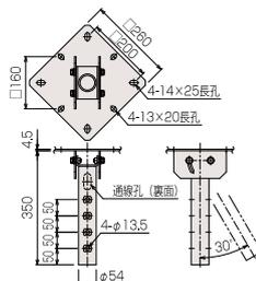
※TH-T30Fとの違いは傾斜機構の取り付け位置が45度回転して製作されています。
